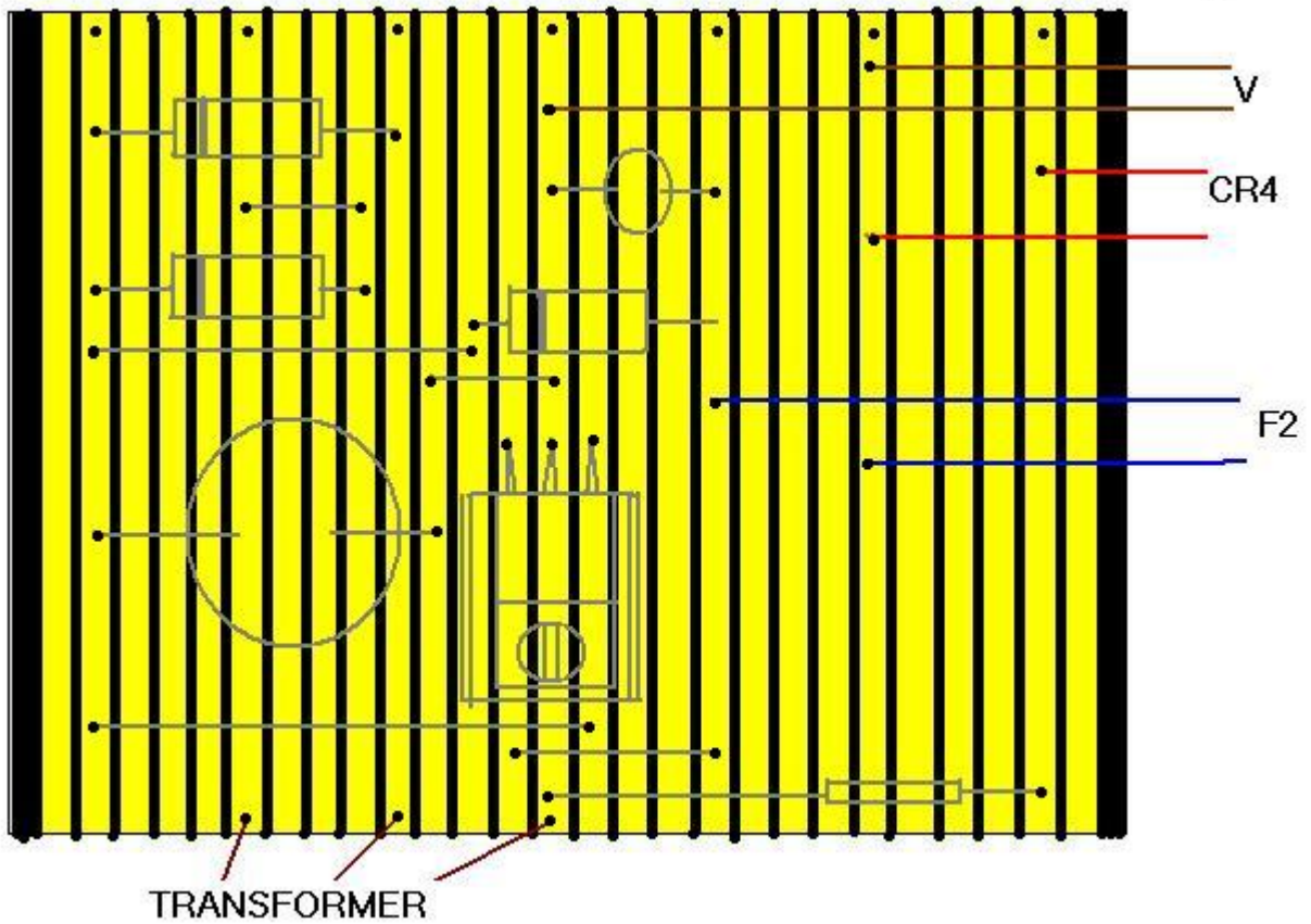
شكل (١٣) يوضح كيفية توصيل العناصر الصغيرة الوزن والحجم على الدائرة المطبوعة
