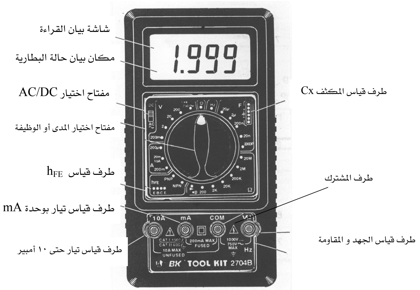
شكل (١) يوضح مكونات جهاز متعدد الأغراض
