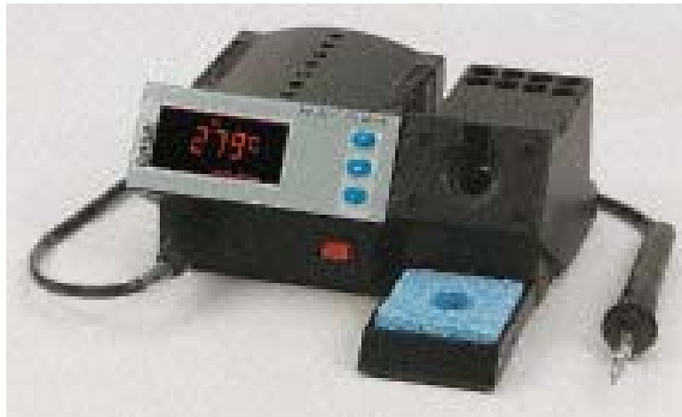
شكل (٤) يوضح كاوية كهربائية قابلة لضبط درجة الحرارة
