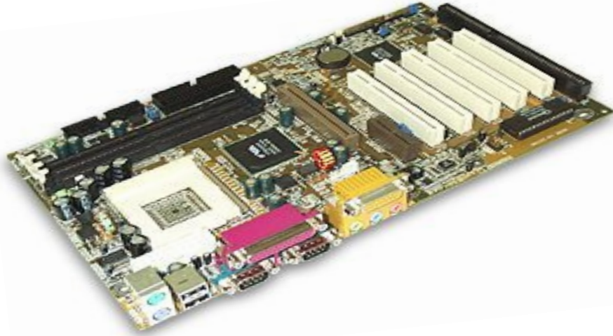
الشكل (٥ - ٣) صورة اللوحة الأم (motherboard)
