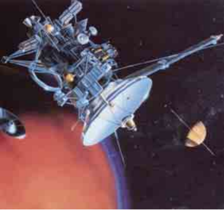
(52) سفينة الفضاء كاسيني في مقدمة الصورة- في طريقها إلى استطلاع تفصيلي لكوكب زحل، وحلقاته، ومجاله المغناطيسي، وأقماره- تقوم بإطلاق المجس هيجنز (أسفل الصورة يسارا) إلى تيتان.
